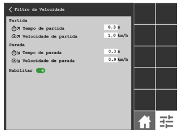
Pantalla de ajustes del filtro de velocidad.
