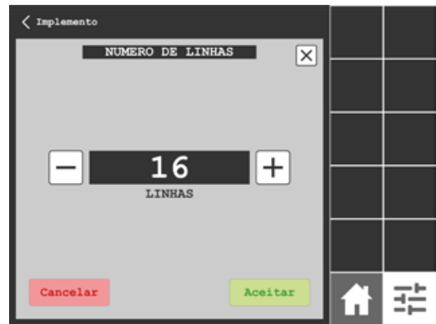
Pantallas de ajustes: Toque el botón + o - para aumentar y disminuir el valor deseado.
