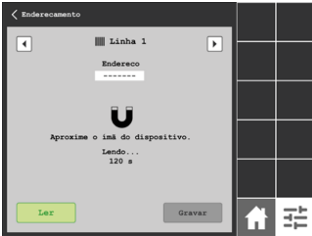
Pantalla de direccionamiento: esperando a que se acerque el imán.
