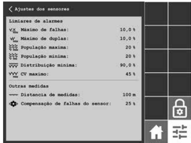
Lista de alarmas configuradas entre máximas y mínimas.
